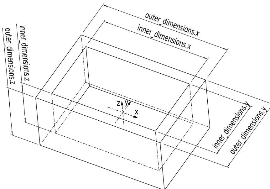
Abb. 6.35: Load Carrier mit Koordinatensystem und inneren und äußeren Abmessungen
