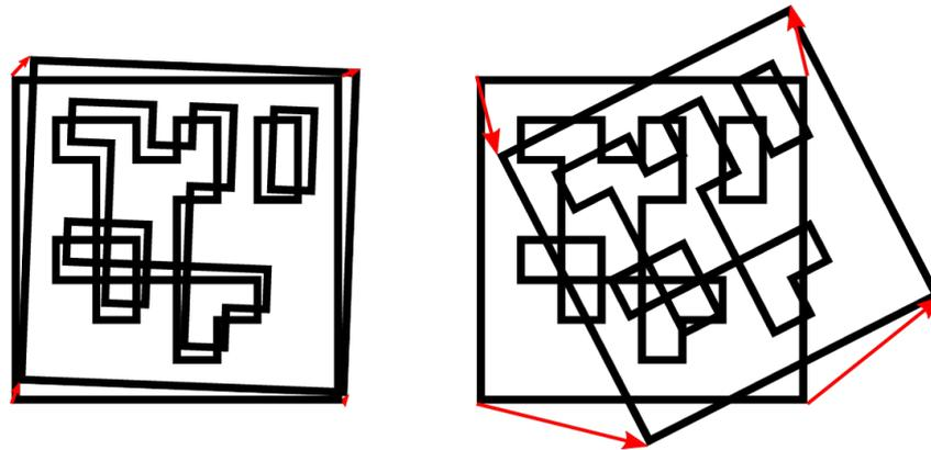
Abb. 6.9: Vereinfachte Darstellung der Tag-Wiedererkennung. Die euklidischen Abstände zwischen zusammengehörigen Tagecken in 3D werden berechnet (rote Pfeile).
