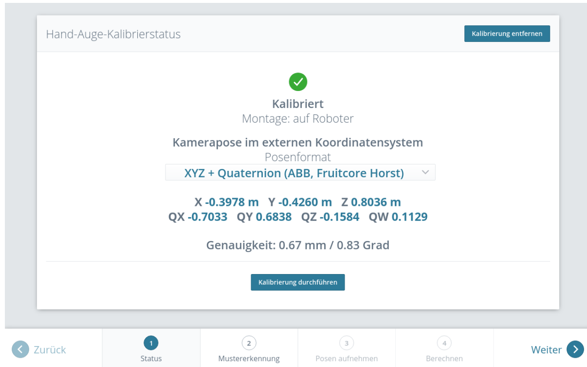
Abb. 6.21: Aktueller Status der Hand-Auge-Kalibrierung falls eine Hand-Auge-Kalibrierung gespeichert ist
