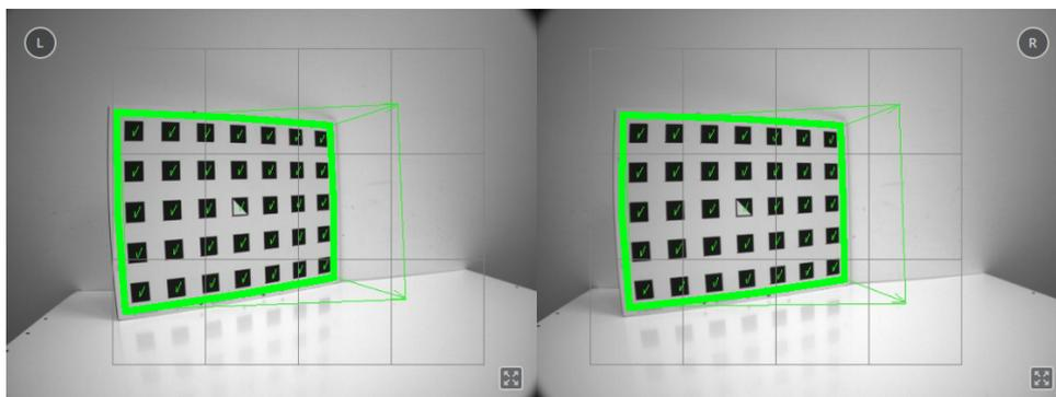
Abb. 6.28: Pfeile weisen darauf hin, wenn das Muster während der Stereokalibrierung nicht senkrecht zur Blickrichtung der Kamera gehalten wird.
