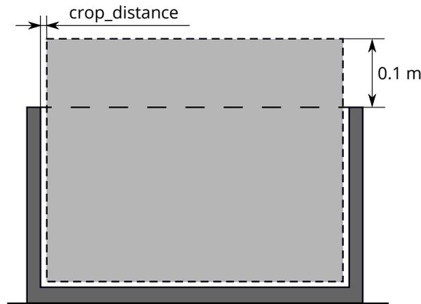
[Abb. 6.36](#): Darstellung des Innenvolumens eines Load Carriers. Nur Punkte, die sich innerhalb dieses Volumens befinden, werden für Detektionen berücksichtigt.
