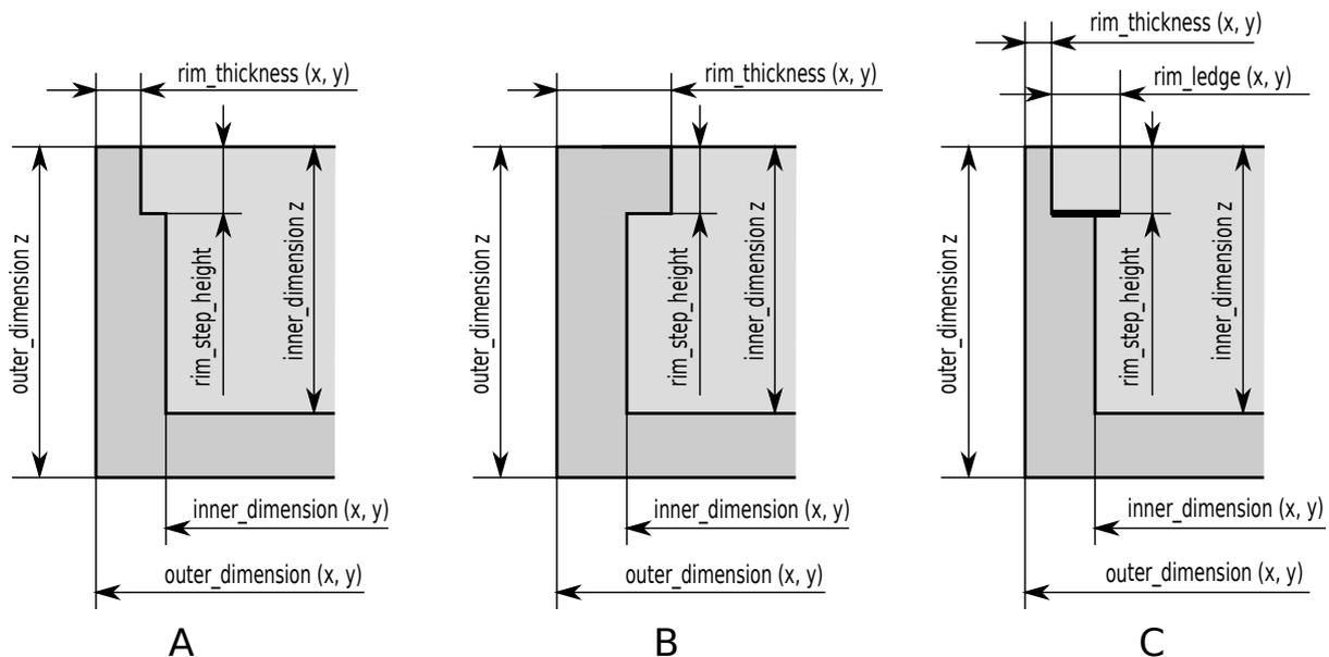
Abb. 6.37: Beispiele von Load Carriern mit abgestuftem (A, B) und vorspringendem Rand (C)
