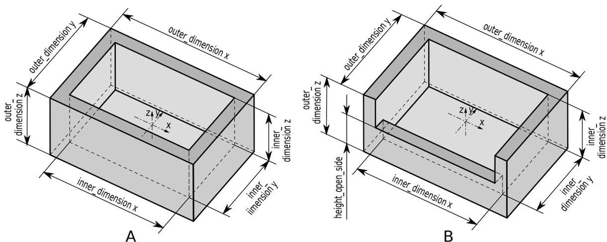
Abb. 6.38: Beispiele eines 4-seitigen (A) und 3-seitigen Load Carriers (B)
