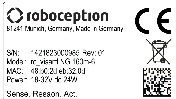
Abb. 4.1: Typenschild des rc_visard NG mit Modellart, Seriennummer und MAC-Adresse
