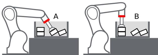
Abb. 6.40: Fall A: Der Griff wird nur als Kollision erkannt, wenn `check_flange` auf `true` gesetzt ist, denn der Flansch (rot) befindet sich im Load Carrier. Fall B: Der Griff ist in jedem Fall kollisionsfrei.
