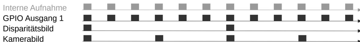
Abb. 6.33: Beispiel für die Nutzung der Betriebsart `ExposureActive` für GPIO-Ausgang 1 mit einer benutzerdefinierten Bildwiederholrate von 8 Hz. Die interne Bildaufnahme geschieht immer mit 25 Hz. GPIO-Ausgang 1 ist für die Dauer der Belichtungszeit jedes Bildes *an* (HIGH). Disparitätsbilder werden für Kamerabilder berechnet, die auch per GigE Vision in der benutzerdefinierten Bildwiederholrate versendet werden.
