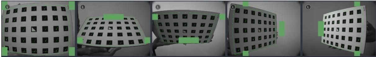
Abb. 6.32: Musterposen für die Monokalibrierung
