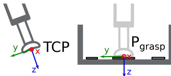
Abb. 6.13: Definition von Greifpunkten bezogen auf den Roboter-TCP
