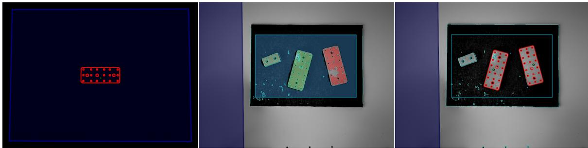
Abb. 6.14: „Template“, „Zwischenergebnis“ und „Ergebnis“ Bilder des SilhouetteMatch Moduls in der Web GUI für eine Detektion mit automatischer Objektebenenerkennung (`object_plane_detection` ist true)
