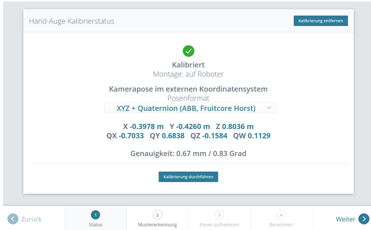
Abb. 6.20: Aktueller Status der Hand-Auge-Kalibrierung falls eine Hand-Auge-Kalibrierung gespeichert ist
