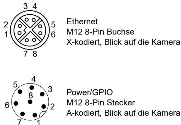
Abb. 3.4: Steckerbelegung für den Strom- und Ethernetanschluss
