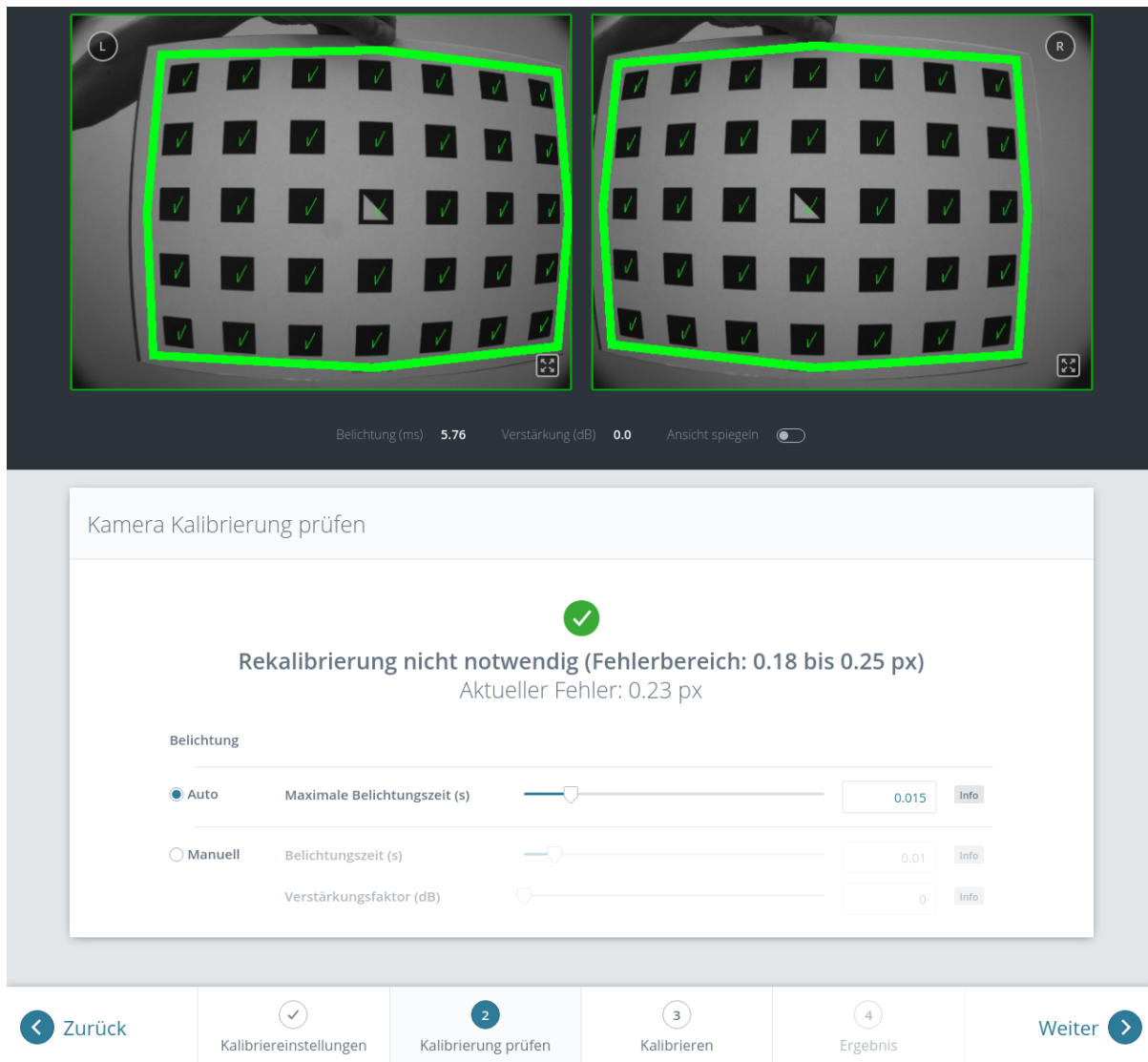
Abb. 6.28: Überprüfung der Kalibrierung
