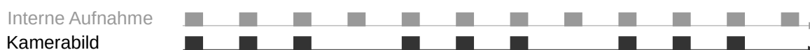
Abb. 6.2: Die interne Bildaufnahme geschieht immer mit 25 Hz. Der fps Parameter bestimmt, wie viele dieser Kamerabilder per GigE Vision versendet werden.
